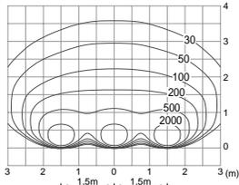
取付位置:壁付 照射角度:水平面より $70^{\circ}$
