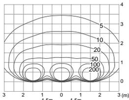
取付位置:壁付 照射角度:水平面より $60^{\circ}$
