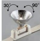
灯具可動機構により、反射板の照射角度を調整可能。軸を支点に90°と垂直方向に30°可動します。
