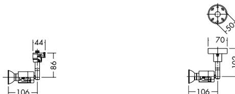
ダイクロハロゲン球(径50mm)75W形65W(E11) 3,000K
