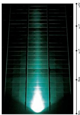
配光写真は壁面に器具を取付けた状態で0°(垂直)の角度で照射しています。
