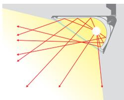
セラミックメタルハライドランプのパワフルな光を、綿密に光学設計された反射板にマルチリフレクトすることでソフトにし、壁面の上から下までの広い範囲へのウォッシングを実現しました。天井と壁面の入隅をはっきりと区別し、壁面のみをムラなく明るくすることで空間をより広く感じさせるライティングが可能になります。
