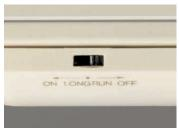
ON(定格)モード:通常出力モード ロングランモード :低出力モード
