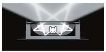
両側配光タイプは、天井面をよりワイドで均一に照射するハイパワーシリーズで す。梁上や、什器に簡単に設置でき、ハイパワーなアッパーライティングを実現 します。
